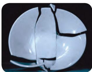
(1/2000秒の世界) 強化磁器破壊の瞬間
