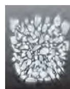
全面物理強化ガラス 破損時
