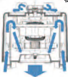
モーター下部に設置された強力なファンが、加熱された空気を吐き出し、常に新鮮な外気でモーターを冷やす様に設計されています。この設計により、本体内部の温度上昇を抑え、連続使用時間10分の実現に至りました。
