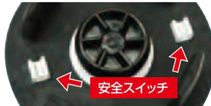
容器と本体の設置部位に2つの安全スイッチを装備。容器が傾くと安全スイッチから外れて自動的に運転が止まり、事故を未然に防ぎます。
