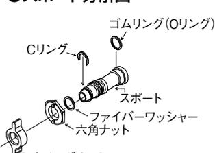
1. ウイングナットをゆるめ、コックを取り外してください。
