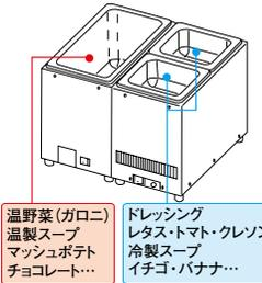
※ビルトインの場合には、吸気(底部)に10cm角以上の開口を設けてください。
