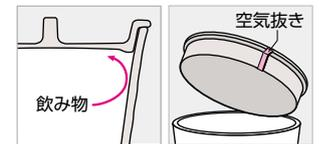
蓋の形状に工夫、飲み物が吹きこぼれにくい設計です。また、空気抜きを設け、中身が冷めても蓋がさっと外せます。
