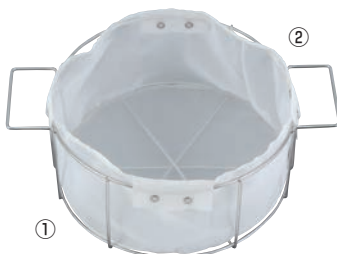
①EBM オイルフィルター 油缶20ℓ用 ページコード 商品コード 価格 1-0924-0101 0390600 ¥7,600 外寸:φ280×H125 アミ目:120メッシュ 耐熱温度:200℃
